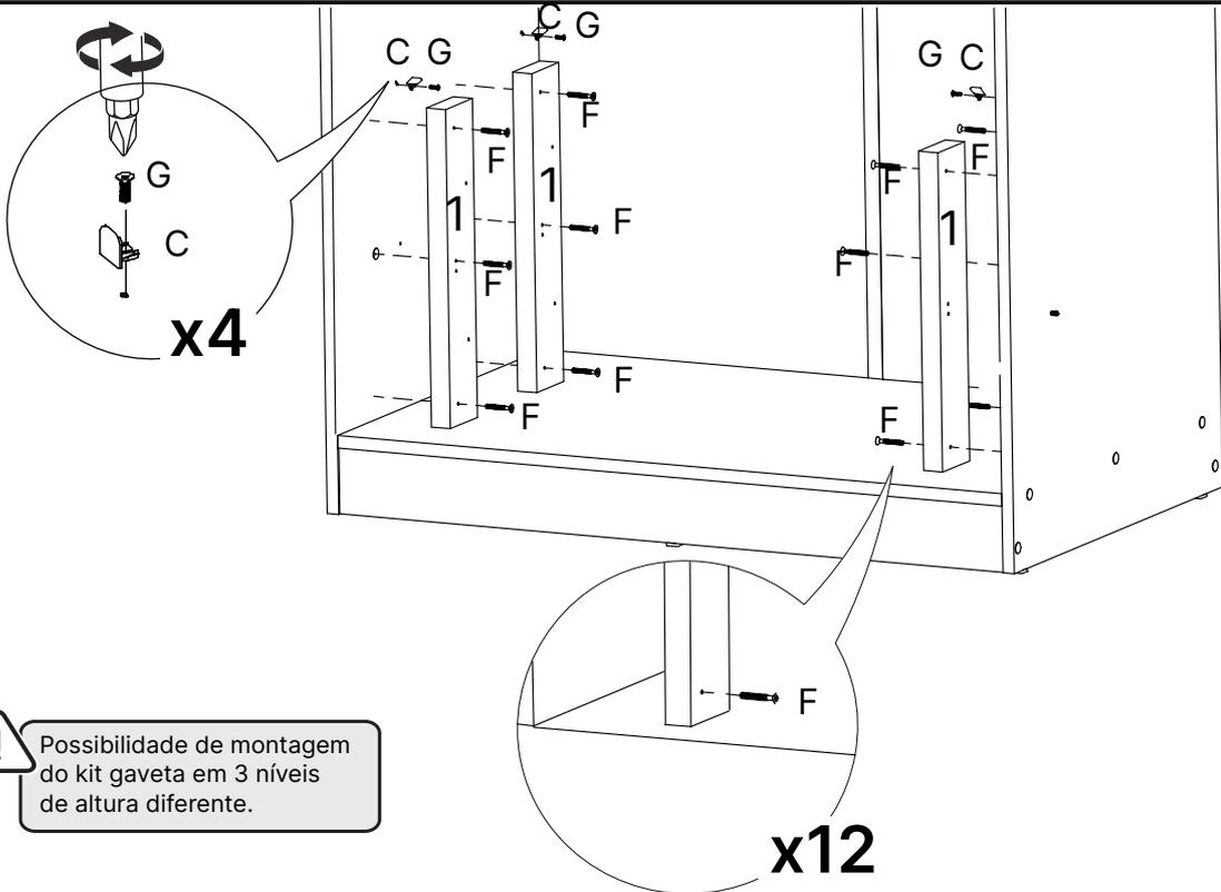
! Possibilidade de montagem do kit gaveta em 3 níveis de altura diferente.
