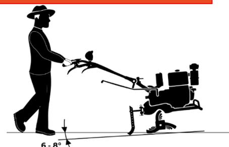
Para obter máxima eficiência na operação do equipamento, mantenha a máquina respeitando a posição indicada na figura acima.
