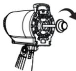
4. Encaixe a grade traseira seguindo orientação do pino guia, no corpo do ventilador. Certifique-se que as 4 travas estão totalmente encaixadas e bem fixas.
