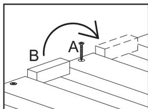
Com a ajuda do espaçador (B), distribua as travessas do estrado [101] e fixe-as usando os parafusos (A).
