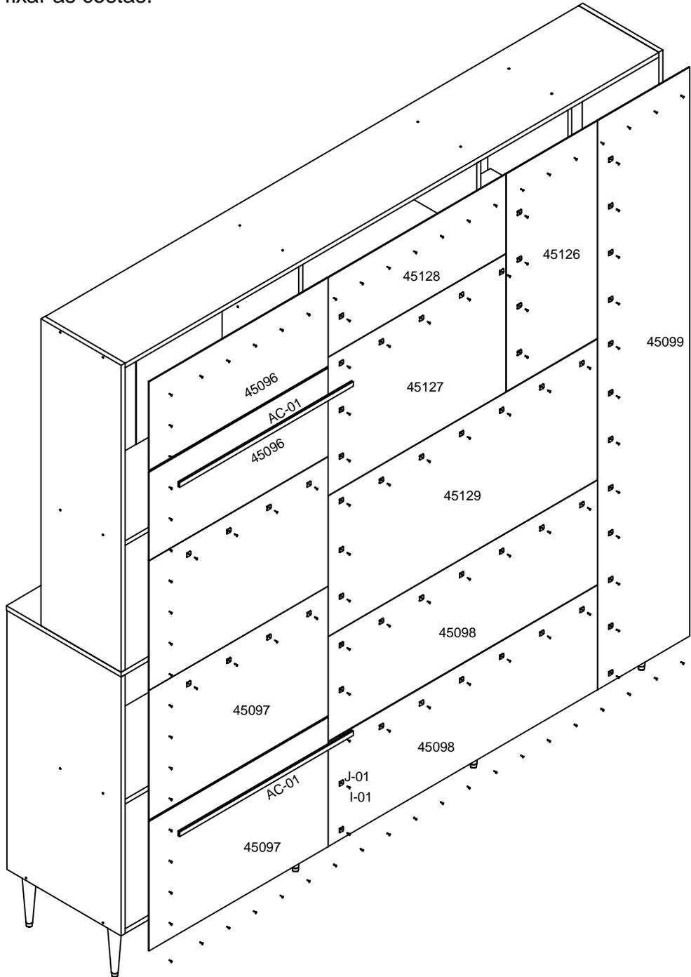
**Passo 1:** Utilizar parafusos B-08 para fixar as corredeiras na lateral e usar cavilas A-01 e minifix B-10 para unir as laterais na frente gaveta.
