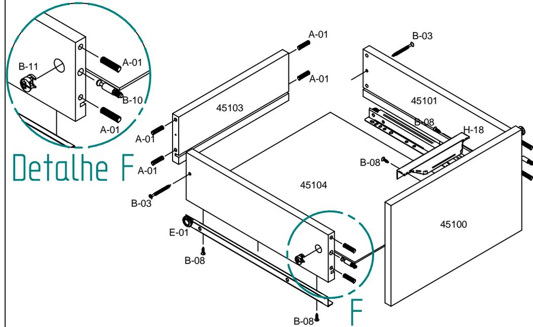
**Passo 2:** Utilizar parafusos B-08 para fixar as corredeiras na lateral e na divisão.
