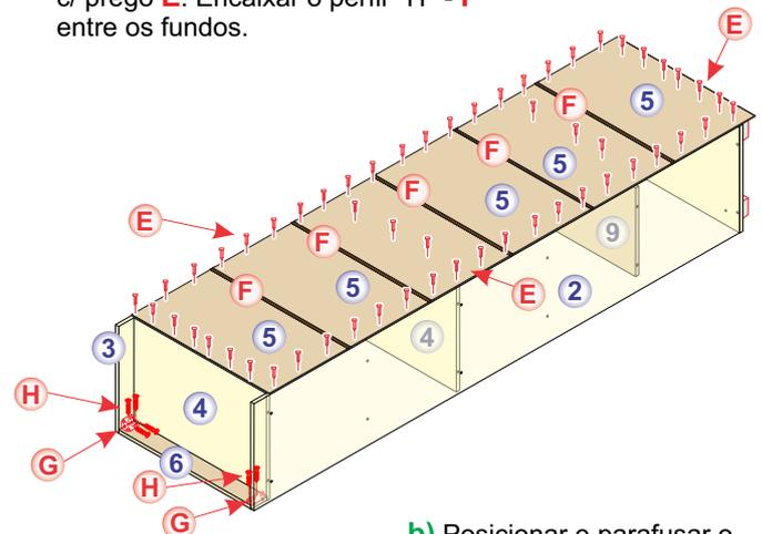
b) Posicionar e parafusar o aplico **6** nas laterais **2** e **3** c/ parafuso **H** cantoneira **G**.
