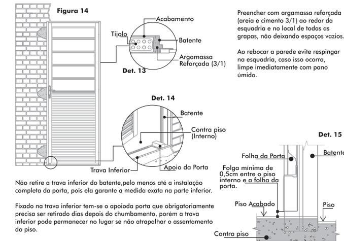
Não retire a trava inferior do batente, pelo menos até a instalação completa da porta, pois ela garante a medida exata na parte inferior.
