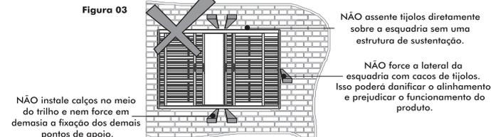
NÃO instale calços no meio do trilho e nem force em demasia a fixação dos demais pontos de apoio.
