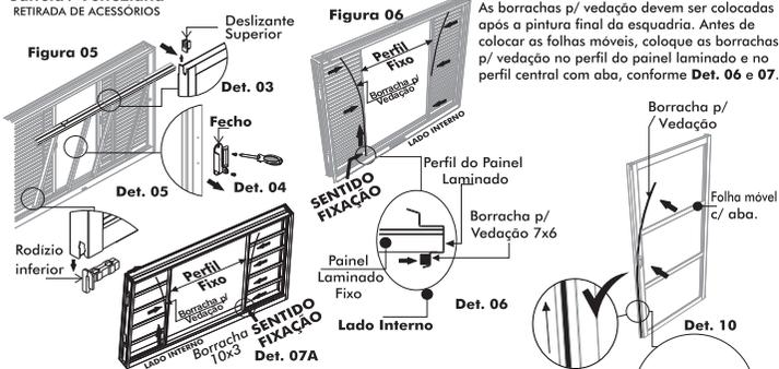
**PROCEDIMENTO:** A fixação das borrachas devem ser feitas de baixo para cima e desde que estejam rente ao trilho inferior e na ponta das folhas móveis. Retire o plástico de proteção do adesivo gradativamente no sentido de fixação de baixo para cima.
