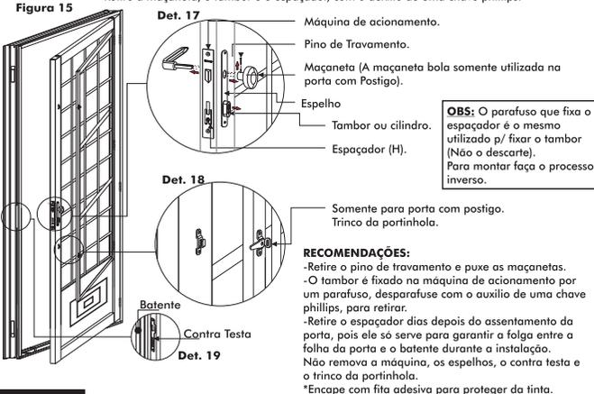
**OBS:** O parafuso que fixa o espaçador é o mesmo utilizado p/ fixar o tambor (Não o descarte). Para montar faça o processo inverso.
