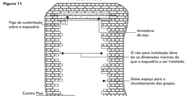
Para atender a NBR 10.821 esse produto deve ser instalado em área coberta, pois não são realizados testes de estanqueidade. Calcule corretamente o espaço para a porta não raspar no piso acabado.
