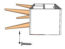
Os pés serão parafusados na base inferior do móvel. Deite o móvel já montado para a instalação dos pés, sera utilizado o parafuso 4,5 x 50 no furo central e parafuso 4 x 40 no furo lateral para a fixação (os pés devem ficar angulados com a quina do móvel).
