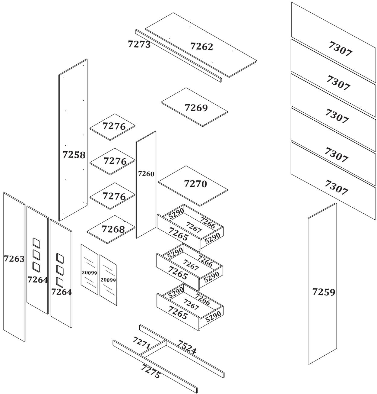
**1** Fixe as sapatas (11063) nos rodapés (7275/7524) e nas laterais (7258/7259) com o parafuso (2503). Em seguida, fixe a cantoneira (2466) com o parafuso (2503). Fixe a base (7268) com o parafuso (2505).
