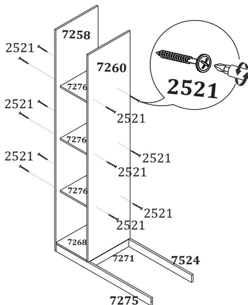
**5** Fixe a lateral (7259) nos rodapés (7275/7524) utilizando o parafuso (2521). Em seguida, fixe as prateleiras (7269/7270), utilizando o parafuso (2521).
