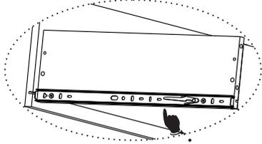
**Fixar a corredeira zerando na parte de baixo da lateral de gaveta, posicione e fixe diretamente com os parafusos (10649).**
