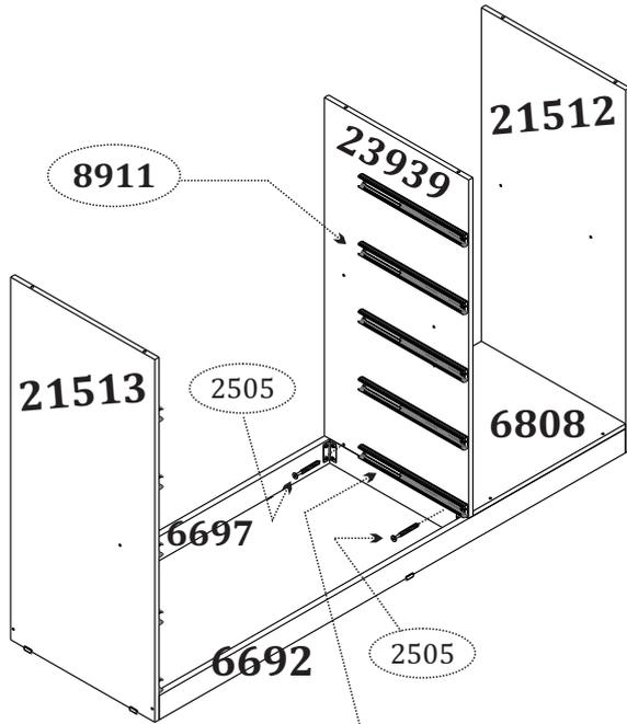
**Obs:** Deixe a corrediça de baixo para fixar depois que a divisão estiver fixada na base, dessa forma terá acesso ao parafuso (2505) que será utilizado na fixação da divisão.
