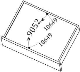
**Obs: Coloque o suporte triangular (9052) no fundo de gaveta, para aumentar sua sustentabilidade utilizando os parafusos (10649).**
