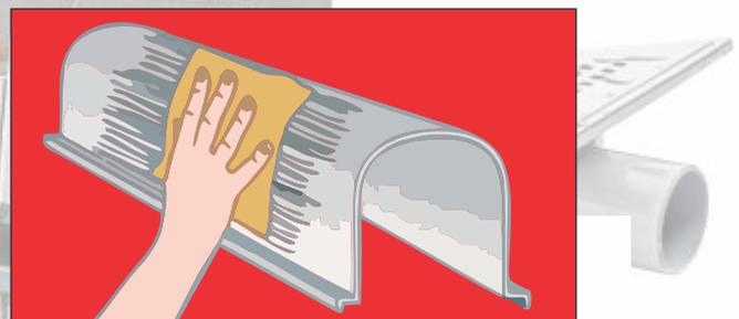
**Passo 6:** Instale a calha juntamente com a grelha, isso evitará que a calha se deforme durante a cura do concreto. Coloque pequenas tiras de papelão entre a calha e a grelha para criar uma folga mínima. Preencha a vala com concreto ou argamassa polimérica.
