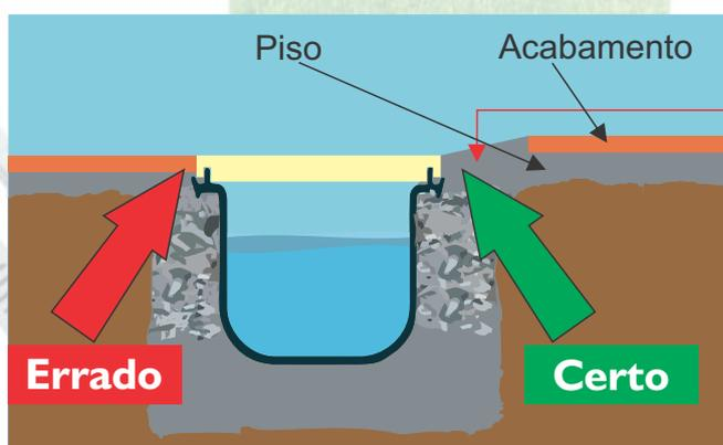
**Passo 8:** O acabamento do piso deve ficar alguns milímetros acima do nível da calha.
