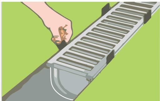
**Passo 7:** Para garantir a uniformidade do alinhamento das calhas, recomenda-se colocar sarrafos de madeira nas duas laterais, posicionando-os transversalmente a cada metro, conforme desenho. Esses sarrafos evitarão torções e desalinhamentos das calhas durante a concretagem.
