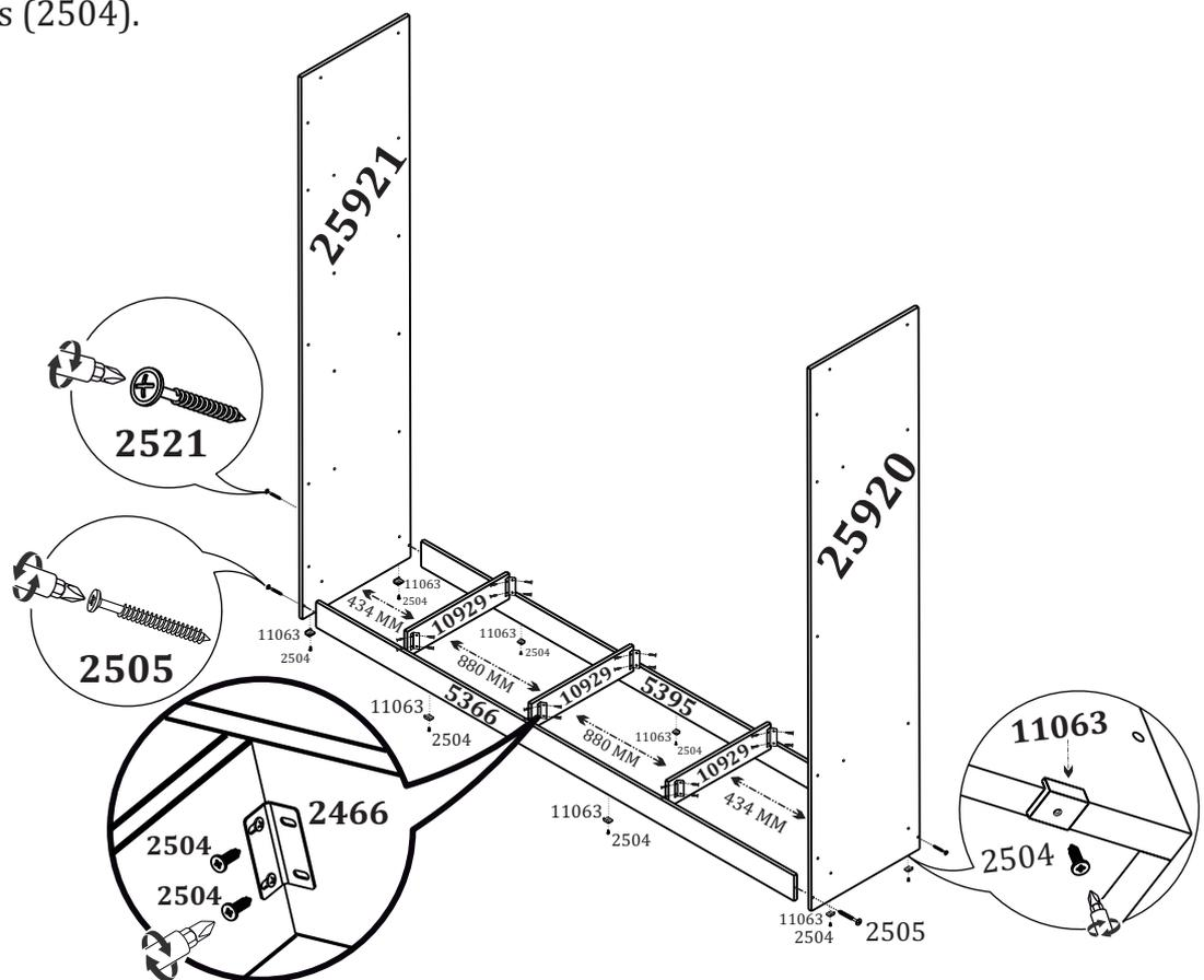
**2** Fixe a base (25925) nas laterais (25920/25921) com os parafusos (2521) e em seguida, fixe nos rodapés (5366/5395) utilizando os parafusos (2505).
