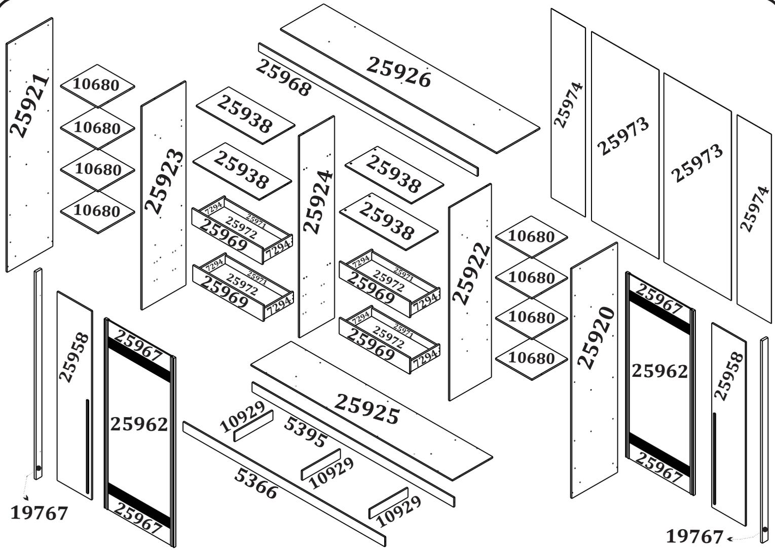
**1** Fixe as sapatas (11063) nas laterais (25920/25921) e nos rodapés (5366/5395) com os parafusos (2504). Fixe as laterais (25920/25921) nos rodapés (5366/5395) utilizando os parafusos (2521) para prender no rodapé traseiro (5395) e os parafusos (2505) para prender no rodapé frontal (5366) em seguida, fixe as travessas (10929) entre os rodapés utilizando as cantoneiras (2466) e os parafusos (2504).
