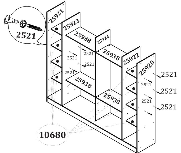
**6** Fixe o tampo (25926) nas cavilhas (2473) das divisões. Em seguida, com os parafusos (2521) fixe o tampo nas laterais (25920/25921).
