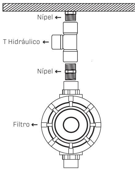
**5- Utilizando os nípeis metálicos, fixe a mangueira de água quente na saída de água quente da parede e a mangueira de água fria no T Hidráulico.**
