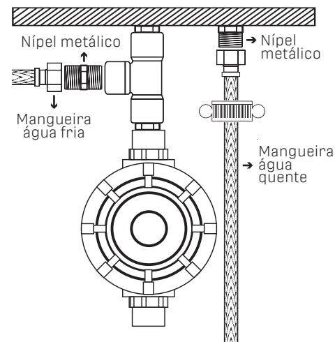
**3- Fixe a rosca no misturador e posteriormente o misturador na bancada, apertando a porca para fixar.**
