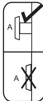
Não fixar totalmente os parafusos ( A ), conforme mostra as imagens de detalhe, para facilitar a montagem da travessa ( 3 ) entre pés ( 02 ) na próxima etapa de montagem.
