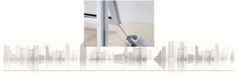
2) Com auxílio de uma chave Philips ou Parafusadeira conforme foto abaixo, retire os parafusos das travessas inferiores.
