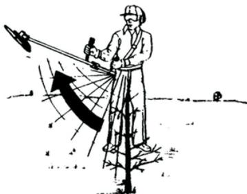
3. Rebote: Ocorre quando se toca algum objeto/material duro com a parte frontal do equipamento. Esta força fará com que o equipamento se mova abruptamente/violentamente para a direita. Este movimento é perigoso uma vez que o movimento é repentino e pode resultar na perda do controle do equipamento.
