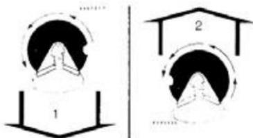
1. Força de Empurrar: Esta ocorre quando se está cortando pelo lado direito do equipamento. O operador sente que o equipamento está sendo empurrado contra si. Caso não se consiga segurar o equipamento, esta força resultará no rebote.
