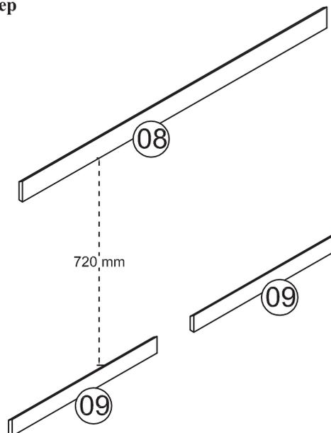
Escolha a altura que dejea colocar o painel da parede e fixe a peça 08 com bucha 08mm e parafuso 5,0 x 90. Depois marque a distancia acima (720 mm) e fixe as peças 09 com bucha 08mm e parafuso 5,0 x 90
