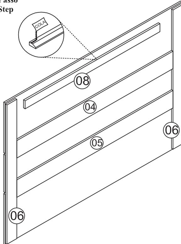
Encoste as peças 06 nas peças 04 e 05 e fixe com parafuso 4,0 x 25 chato. Fixe a peça 08 na peça 03 com cola, cavilha e parafuso 4,0 x 25 chato.
