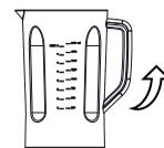
Com o auxílio de uma ferramenta apropriada, posicione-a no orifício inferior da alça, puxando-a para fora do copo até soltar totalmente.
