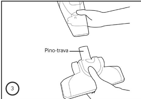
3. Para utilizar o bico múltiplo, encaixe-o no bocal do aspirador, como indicado na imagem.
