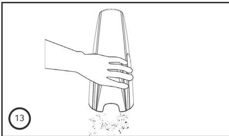
13. Despeje a sujeira dentro de uma lixeira. Se necessário você poderá remover a sujeira manualmente ou lavar o recipiente com água corrente. Encaixe as peças novamente para usar o produto.
