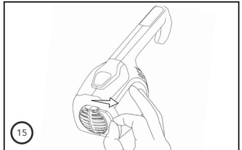
15. Se o filtro da entrada do ar no motor estiver sujo a limpeza deve ser igual a limpeza do filtro HEPA.
