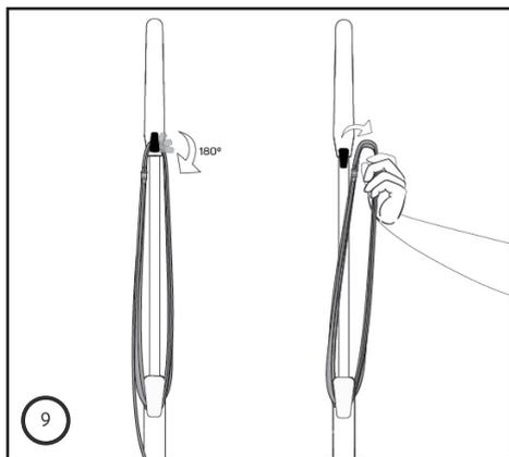
9. A haste extensora conta com um suporte para cabo elétrico. Para retirar o cabo do suporte rotacione o pino no sentido horário até ele apontar para baixo e retire todo o cabo elétrico do suporte. Plugue o cabo em uma tomada compatível com a tensão de seu aspirador, ligue-o e inicie o trabalho.
