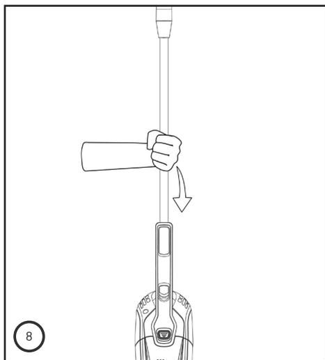
8. Para utilizar a haste extensora do aspirador, coloque a haste no corpo do produto e pressione para baixo até a trava fazer um estalo.
