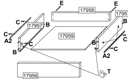
**Gavetas** - Parafusar as laterais de gaveta ao lenço da gaveta com o parafuso (E); encaixar o fundo no rasgo, fixe a frente com a cavilha (B) e cantoneira (T); a corredeja (A2) deve ser parafusada na lateral (17957) com o parafuso (C) na posição horizontal.
