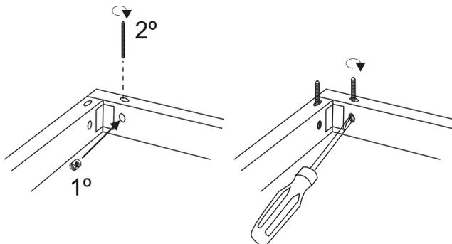
Os pés devem ser encaixados no tampo com os parafusos fixados, conforme figura.
