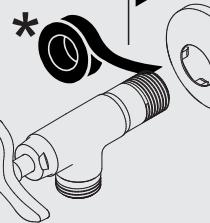
**PARA INSTALAÇÃO ONDE A PRESSÃO É SUPERIOR A 15 M.C.A (1,5 KGFCM<sup>2</sup>) O RESTRITOR DE FLUXO (\*) DEVE SER INCLUÍDO ANTES DA INSTALAÇÃO.**
