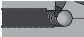
A **escória** é uma parte importante para a qualidade do processo de eletrodo revestido, ela protege a solda contra impurezas. Após finalizado é aconselhado que se retire a escória com uma picadeira de solda.
