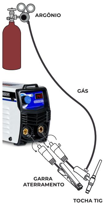
1 - Conecte a **tocha tig** ao pólo negativo da máquina e tenha certeza de que ao girar o mesmo esteja bem fixado. Evite o mau contato.
