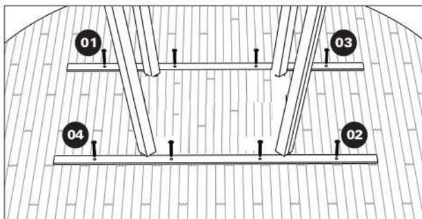
Com o auxílio de uma trena meça e centralize a estrutura de metal sobre o tampo. **ATENÇÃO:** posicione a estrutura de metal no sentido contrário ao das ripas que formam o tampo de madeira. Após posicione os parafusos (8 uni.) nos orifícios da estrutura de metal. Inicie aparafusando os quatro parafusos indicados na imagem na ordem que estes estão numerados. Aparafuse de maneira progressiva, apertando cada parafuso um pouco por vez. Em seguida fixe os demais parafusos.
