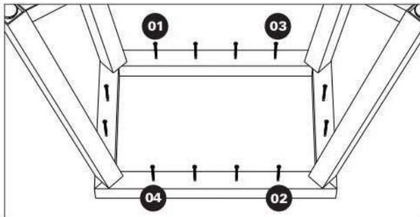
Com o auxílio de uma trena meça e centralize a estrutura de metal sobre o tampo. Após posicione os parafusos (12 uni.) nos orifícios da estrutura de metal. Inicie aparafusando os quatro parafusos indicados na imagem na ordem que estes estão numerados. Aparafuse de maneira progressiva, apertando cada parafuso um pouco por vez. Em seguida fixe os demais parafusos.
