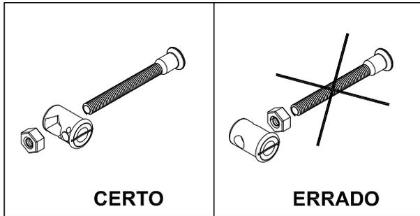
**13°** - Monte as cabeceiras nos rodapés laterais, fixando os parafusos CAB11 SXINT 1/4"x60 s/ pont nas buchas com as porcas. Se necessário, use a chave de fenda para alinhar as buchas dentro das furações.
