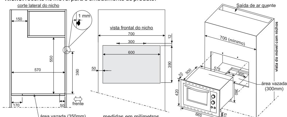
Antes de iniciar a instalação do Forno Elétrico de Embutir Fischer, verificar se o nicho de embutimento (espaço em que o forno será embutido), está seguindo rigorosamente as dimensões e cortes conforme especificado nas figuras. O móvel para embutimento deverá ser de madeira tipo MDF e/ou maciça.
