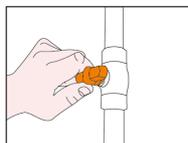
**1.** Escolha um local de fácil acesso para instalar o Cap Facile®. Feche o registro de água anterior ao ponto de instalação desejado. Abra a torneira e elimine a água da tubulação.
