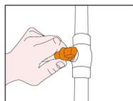
**1.** Feche o registro de água anterior ao ponto de instalação desejado. Abra a torneira e elimine a água da tubulação.
