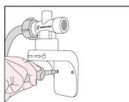
**4.** Após retirar a mangueira de saída, desinstale o Cap Facile® da parede e mantenha a mangueira de entrada instalada.
