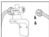
**3.** Retire a mangueira de saída do Cap Facile®. Lembre-se de que pode existir água entre a saída de água e a torneira, então utilize um recipiente para coletar a água excedente.
