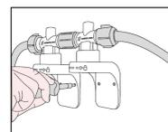
**6.** Parafuse o conjunto de Cap Facile® na posição desejada. Após, instale a mangueira de saída no último Cap Facile®. Encaixe os Refis Purificadores Facile® e gire 1/4 de volta para a direita. Confira em [hidrofiltros.com.br/facile](http://hidrofiltros.com.br/facile) como conectar os Refis Purificadores Facile® na sequência ideal.
