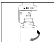
**2.** Desencaixe o Refil Purificador Facile® girando 1/4 de volta para a esquerda.
