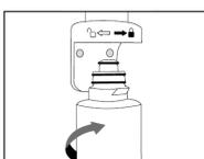
**4.** Encaixe o Refil Purificador Facile® e gire 1/4 de volta para a direita.
