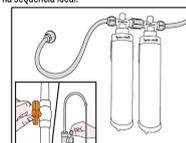
**7.** Garanta que todas as conexões estejam livres de vazamento, conferindo os componentes de vedação. Abra o registro geral de água. Descarte os primeiros 15 litros até que a água fique cristalina. Uau! Agora você pode desfrutar de uma água purificada.
