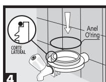
Observe se o anel o-ring utilizado para a vedação do filtro está devidamente alojado na tampa (cód. 2237-70B). Não utilize fita vedante roscada na tampa do filtro.
