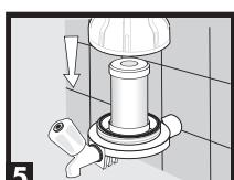
Encaixe o elemento filtrante na tampa ou copo (conforme posição do copo). Enrosque o copo de volta na tampa. Ligue o registro geral.
