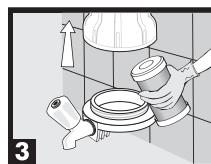
Com uma luva, retire o elemento filtrante cheio de impurezas. Lave a tampa e o copo do filtro com água e sabão biodegradável.
