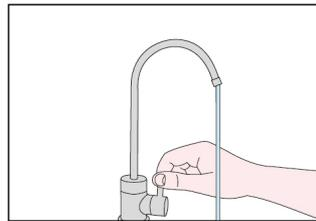
**3.** Garanta que todas as conexões estejam livres de vazamento, conferindo os componentes de vedação. Abra o registro geral de água. Descarte os primeiros 15 litros até que a água fique cristalina. Uau! Agora você pode desfrutar de uma água purificada.
