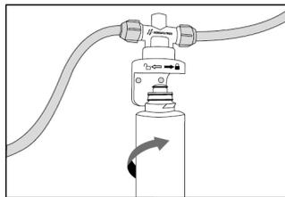
**2.** Certifique-se de que os três anéis de vedação estão no alojamento. Encaixe o Refil Purificador Facile® e gire 1/4 de volta para a direita. Pronto! Troca do refil realizada.
