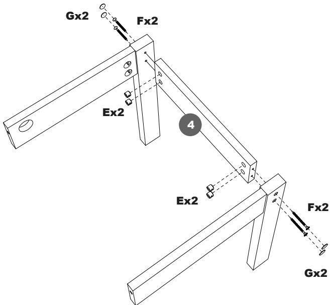
Utilize as porcas cilíndricas (E) com os parafusos 5x50 (F) para fixar os conjuntos montados anteriormente na travessa inferior (4). Depois, cubra os parafusos com os tapa-furos adesivos (G).
