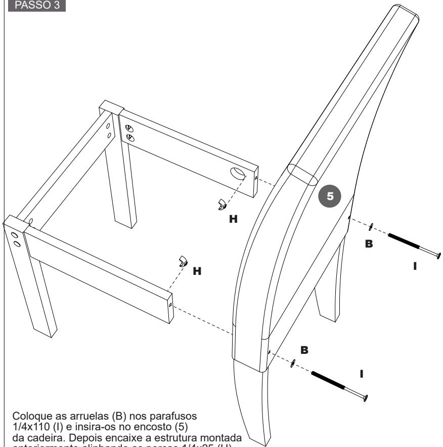
Coloque as arruelas (B) nos parafusos 1/4x110 (I) e insira-os no encosto (5) da cadeira. Depois encaixe a estrutura montada anteriormente alinhando as porcas 1/4x25 (H). Aperte um pouco os parafusos com a mão e depois siga ao próximo passo.
