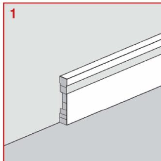
1 Posicione o rodapé de PVC Bariri no local onde será instalado e marque a direção do corte.
