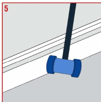
5 Utilizando uma marreta de borracha, bata suavemente para melhor assentamento do rodapé e da cola na parede.
