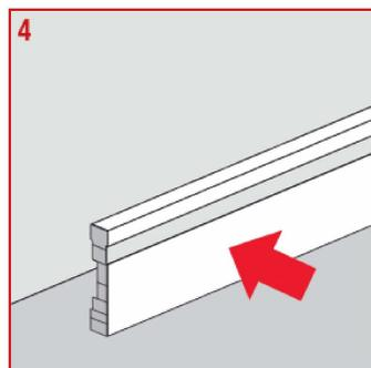
4 Após a aplicação da cola, posicione o rodapé na parede e o pressione com as mãos.
