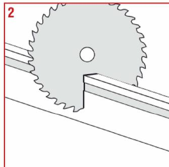
2 Coloque a peça de rodapé de PVC na prancha de corte e realize o corte seguindo a marcação.
