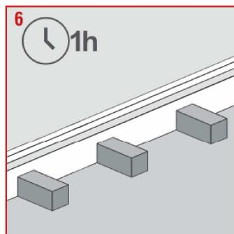
6 Mantenha por uma hora alguns pesos pressionando o rodapé contra a parede para melhorar a fixação.
