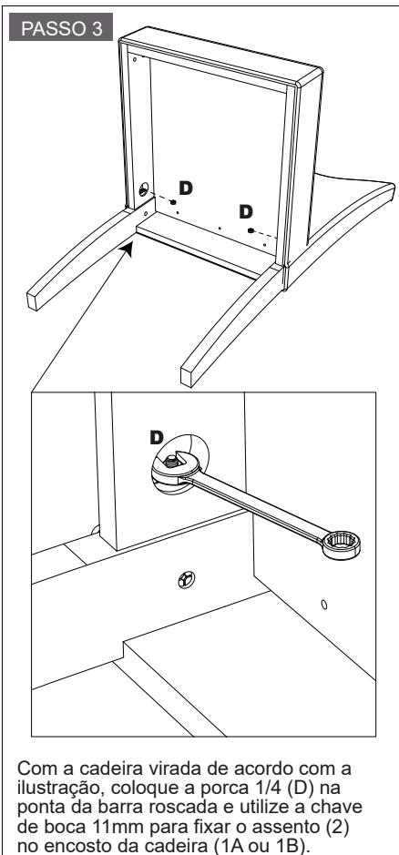
Com a cadeira virada de acordo com a ilustração, coloque a porca 1/4 (D) na ponta da barra rosada e utilize a chave de boca 11mm para fixar o assento (2) no encosto da cadeira (1A ou 1B).
