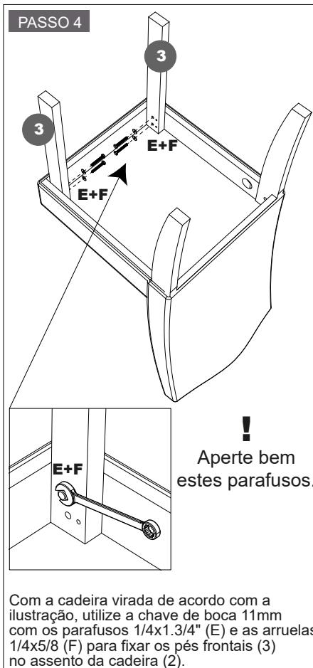
Com a cadeira virada de acordo com a ilustração, utilize a chave de boca 11mm com os parafusos 1/4x1.3/4" (E) e as arruelas 1/4x5/8 (F) para fixar os pés frontais (3) no assento da cadeira (2).
