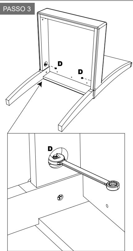
Com a cadeira virada de acordo com a ilustração, coloque a porca 1/4 (D) na ponta da barra rosada e utilize a chave de boca 11mm para fixar o assento (2) no encosto da cadeira (1A ou 1B).
