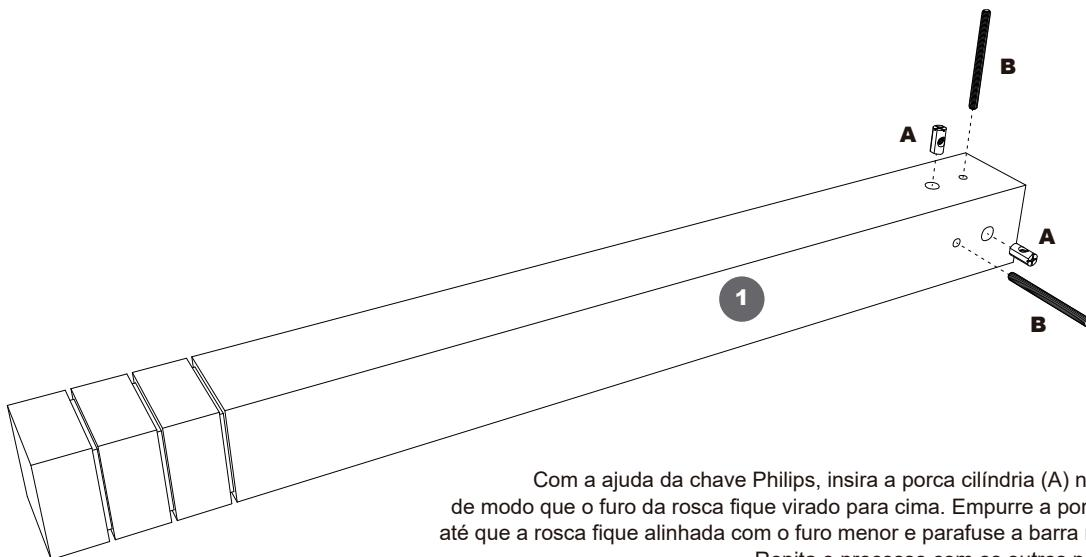
Com a ajuda da chave Philips, insira a porca cilíndrica (A) no furo maior de modo que o furo da rosca fique virado para cima. Empurre a porca cilíndrica até que a rosca fique alinhada com o furo menor e parafuse a barra roscada (B). Repita o processo com os outros pés da mesa.
