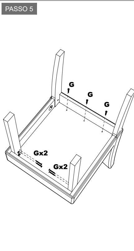
Utilize uma chave Philips com os parafusos 5x40 (G) para reforçar a fixação dos pés frontais (3) e o assento da cadeira (2).
