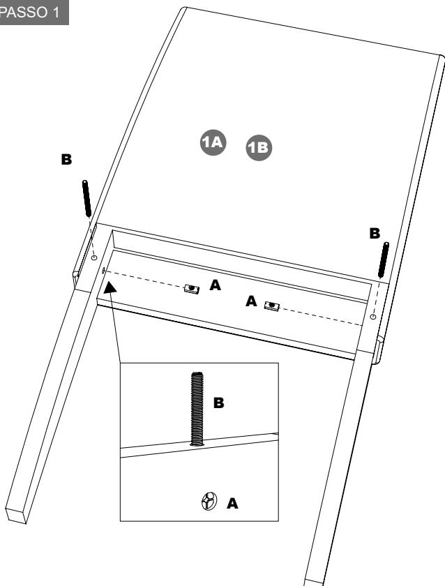
Coloque as porcas cilíndricas (A) nos locais indicados, depois coloque as barras rosadas (B) nas porcas cilíndricas (A) girando-a com as mãos. É necessário que a barra dê pelo menos 5 voltas completas para garantir a fixação da cadeira.
