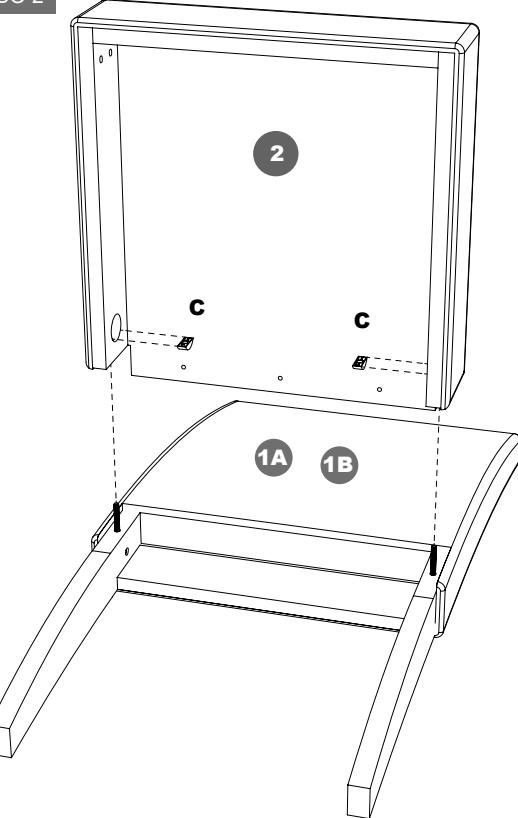
Coloque as arruelas meia-lua (C) no assento (2). Depois encaixe o assento (2) no encosto (1) utilizando as barras rosadas (B) fixadas anteriormente.
