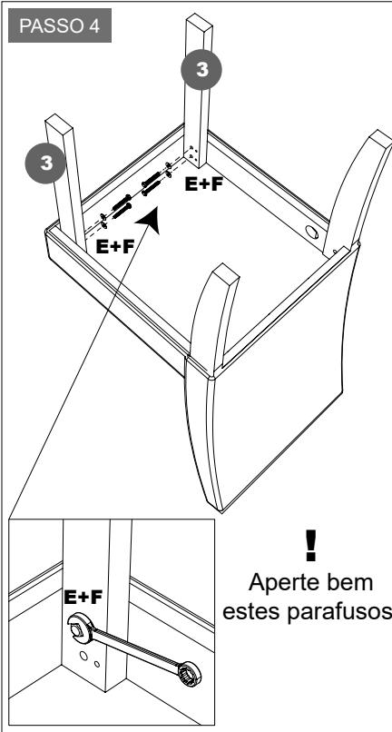
Com a cadeira virada de acordo com a ilustração, utilize a chave de boca 11mm com os parafusos 1/4x1.3/4" (E) e as arruelas 1/4x5/8 (F) para fixar os pés frontais (3) no assento da cadeira (2).
