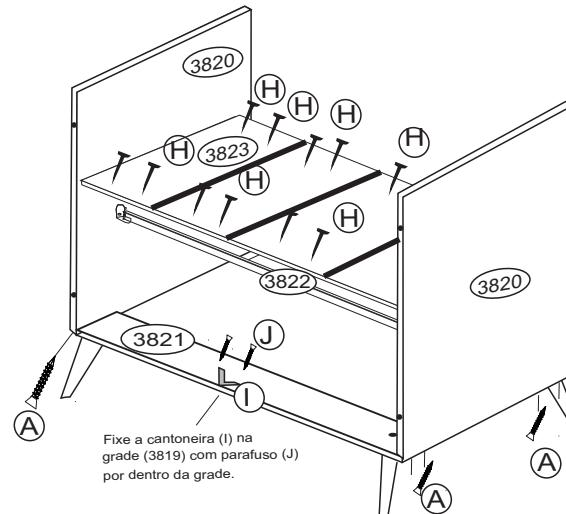
O parafuso (A) não pode ser removido durante a desmontagem.
