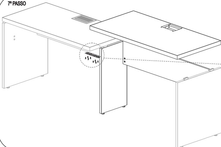
**ENCAIXE AS BARRA DE CONEXÃO 180mm ENTRE OS TAMPOS FIXANDO COM OS PARAFUSOS 4,5 X 16 CAB. PANELA CONFORME O INDICADO**
