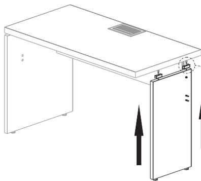
**POSICIONE OS ESPAÇADORES METALIZADOS E ENCAIXE O PÉ PAINEL CENTRAL DO COMPLEMENTO FIXANDO COM OS PARAFUSOS MINIFIX**
