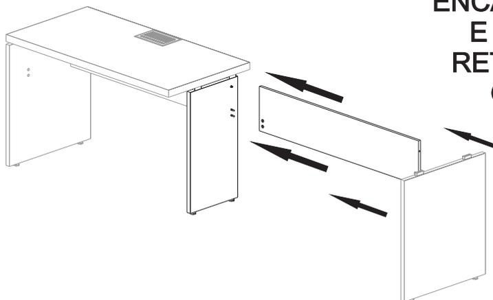
**ENCAIXE A RETAGUARDA NO PÉ CENTRAL E ENCAIXE O PÉ PAINEL LATERAL NA RETAGUARDA FIXANDO COM OS PINOS GIROFIX CONFORME O INDICADO**
