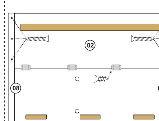
Fixar as peças 08 e 11 na peça 01 com Parafuso 3,5x25.
