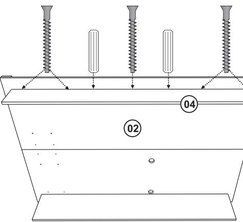
Fixar a peça 04 na peça 02 com Parafuso 5x50 e Cavilha 6x30.
