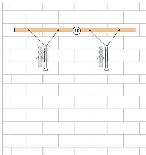
Fixar a cunha de fixação 10 na parede com Parafuso 6x80 e Bucha 10.
