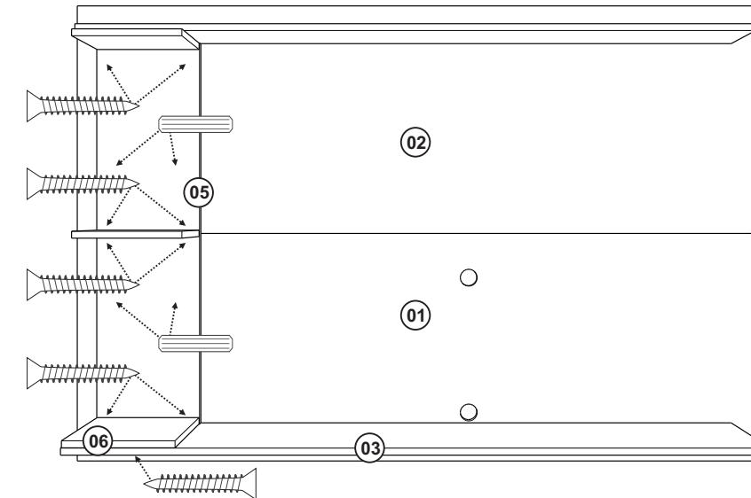
Fixar a peça 05 nas peças 01 e 02 com Parafuso 3,5x25 e Cavilha 6x20. Fixar a peça 06 na peça 03 com Parafuso 3,5x25
