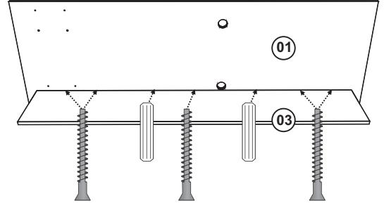
Fixar a peça 03 na peça 01 com Cavilha 6x30 e Parafuso 5x50
