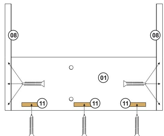
Fixar as peças 08 e 11 na peça 01 com Parafuso 3,5x25.
