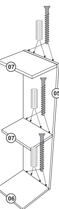
Fixar as peças 06 e 07 na peça 05 com Parafuso 5x50 e Cavilha 6x20.
