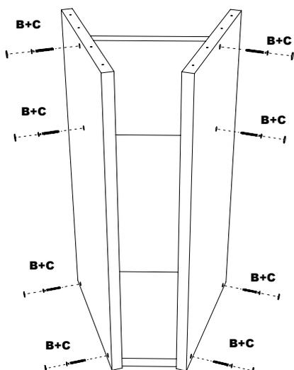
Fixe as peças utilizando os parafusos 5x50 (B) e depois cubra os parafusos utilizando os tapa-furos (C).
