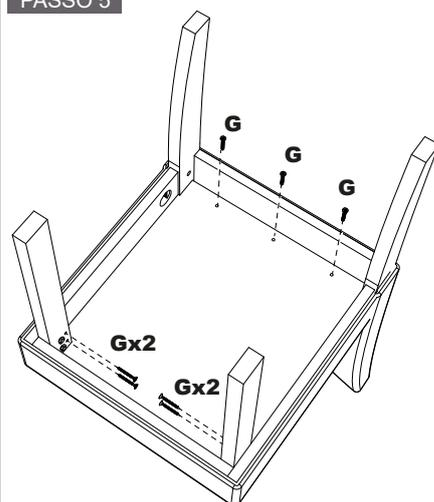
Utilize uma chave Philips com os parafusos 5x40 (G) para reforçar a fixação dos pés frontais (2) e o assento da cadeira (1A ou 1B).
