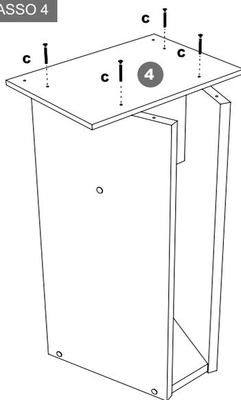
Fixe o apoio do tampo (4) utilizando os parafusos 5x50 (B).
