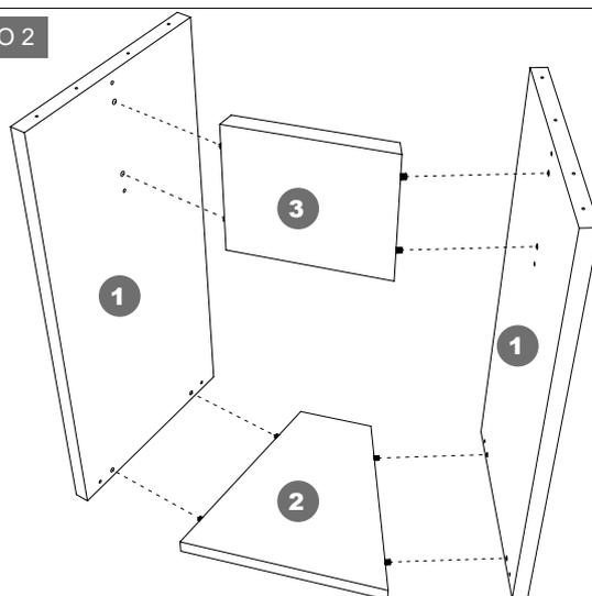
Encaixe as laterais da base (1) no trapézio e nas travessa utilizando as cavilhas (A) como guias
