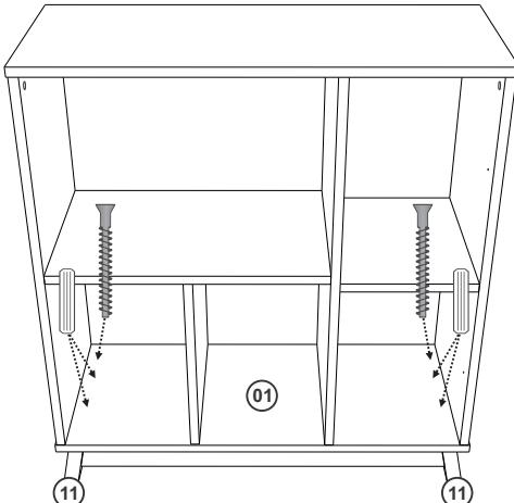
Fixar os Pés 11 na peça 01 com Parafuso 5x40 e Cavilha 6x20.
