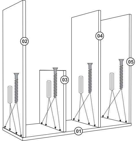
Fixar as peças 02, 03, 04 e 05 na peça 01 com Cavilha 6x30 e Parafuso 5x40.
