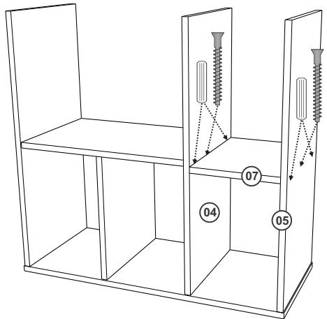
Fixar a peça 07 nas peças 04 e 05 com Cavilha 6x30 e Parafuso 5x40.
