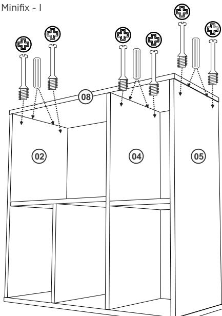
Fixar a peça 08 nas peças 02, 04 e 05 com Cavilha 6x30 e Minifix.
