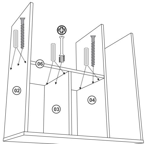
Fixar a peça 06 nas peças 02 e 04 com Parafuso 5x40 e Cavilha 6x30 e fixar na peça 03 com Minifix e Cavilha 6x30.
