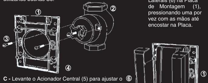
**B** - Monte as Molduras Laterais (6) na Placa de Montagem (1), pressionando uma por vez com as mãos até encostar na Placa.
