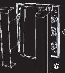
**C** - Levante o Acionador Central (5) para ajustar o parafuso de regulagem da Base (7), assim obtendo a posição ideal de funcionamento do conjunto.
