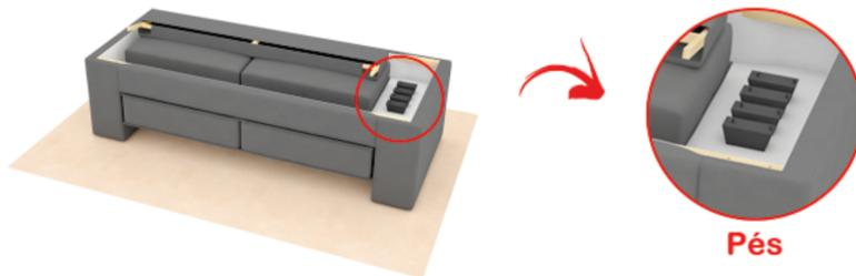
Faça a montagem dos pés, fixando-os nos furos existentes no suporte da parte inferior do produto
