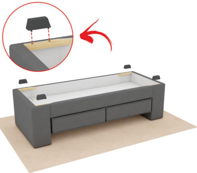
Faça o procedimento de encaixe, com o encosto nivelado, colocando o suporte de madeira na guia de madeira presente na estrutura da base.
