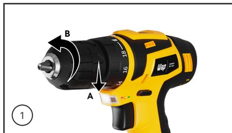
1. Para abrir o mandril, segure a parte A e gire no sentido anti-horário a parte B até obter a abertura necessária para inserir o acessório que será utilizado.
