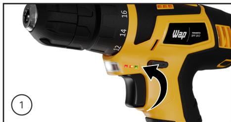
1. A sua ferramenta possui um indicador de nível da bateria o qual permite identificar se o nível de carga da bateria está baixa, média e alta. Quando os indicadores estiverem apagados, realizar o carregamento do produto.
