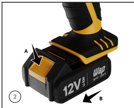
2. Para remover a bateria da ferramenta, pressione o botão de liberação (A) e ao mesmo tempo desconecte a bateria movendo para frente (B).
