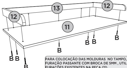
PARA COLOCAÇÃO DAS MOLDURAS NO TAMPO, É NECESSÁRIO FAZER A FURAÇÃO PASSANTE COM BROCA DE 5MM, UTILIZANDO COMO BASE AS PRÉ FURAÇÕES EXISTENTES NA PEÇA (11).
