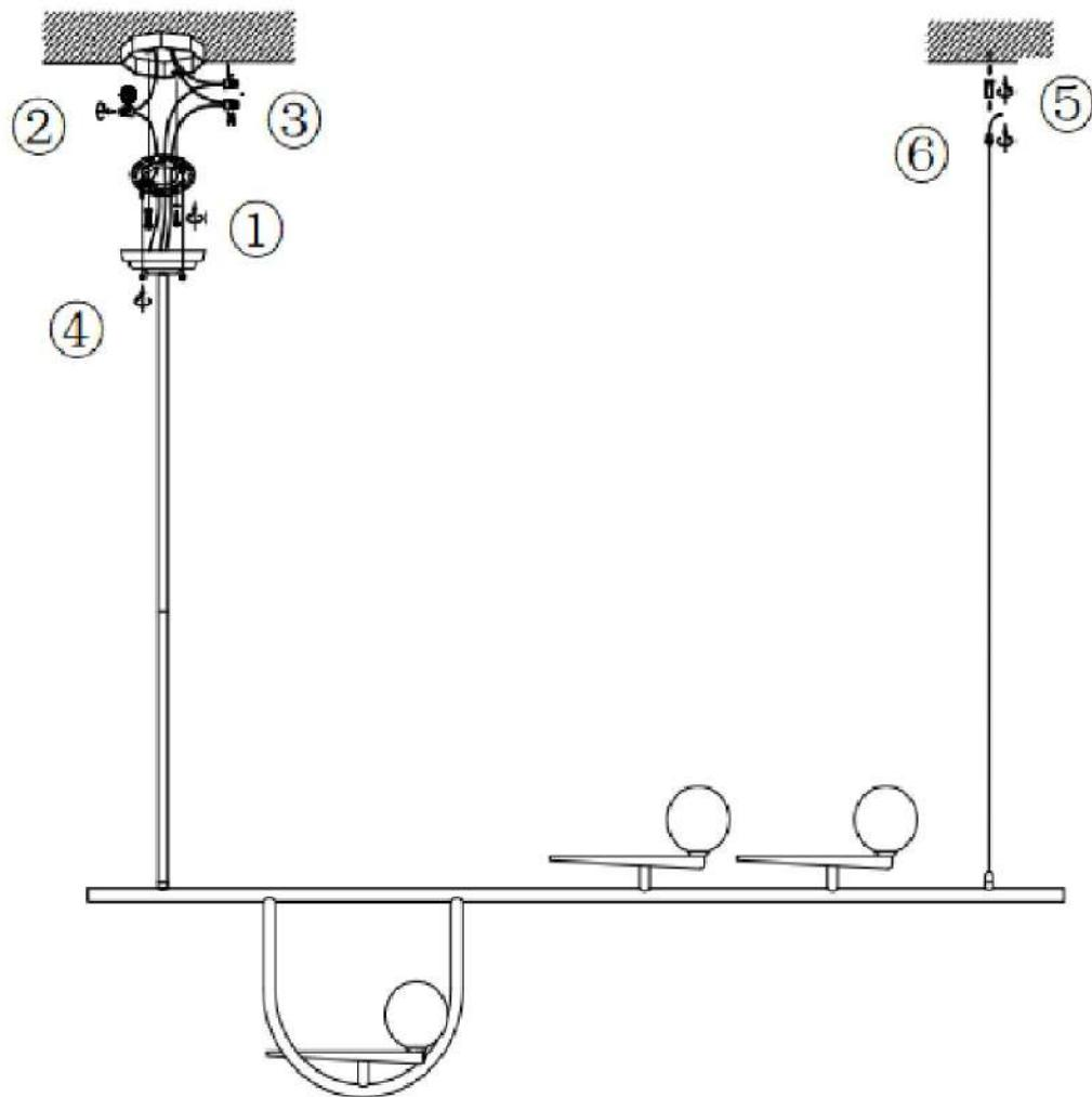
**1 E 2. FIXE AS BUCHAS NO TETO E FIXE A TRAVESSA COM OS PARAFUSOS NO TETO.****3 E 4. CONECTE OS FIOS ELÉTRICOS À REDE ( CERTIFIQUE-SE QUE ELA SE ENCONTRE DESLIGADA). E FIXE A CANOPLA NO TETO.****5 E 6. FIXE O PINO DO CABO DE AÇO NO TETO NO LOCAL DESEJADO E AJUSTE A ALTURAS DOS CABOS.****INSTALE AS LÂMPADAS (NÃO ACOMPANHAM O PRODUTO) E INSTALE AS CÚPULAS DE VIDRO ROSQUEANDO-AS.**Para sua segurança, preencha
