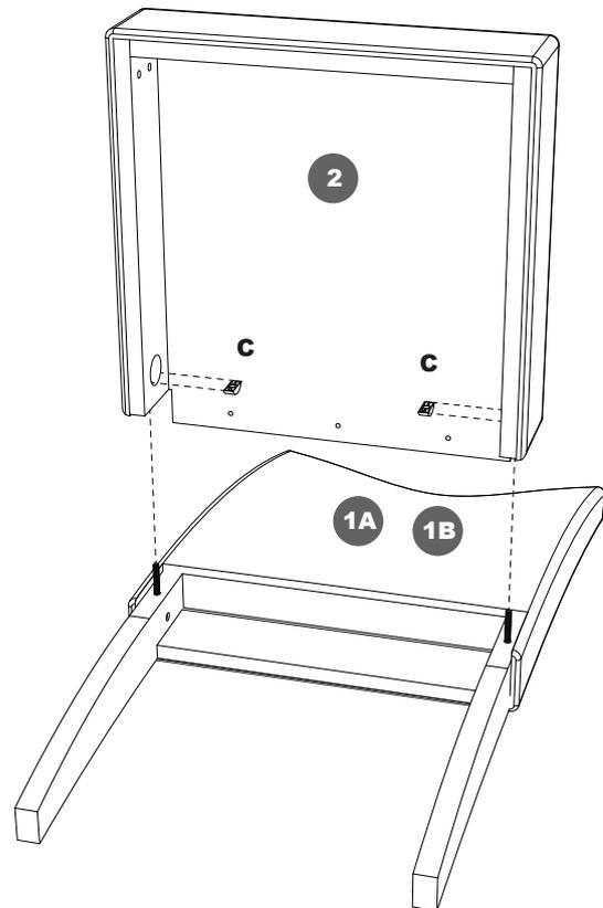
Coloque as arruelas meia-lua (C) no assento (2). Depois encaixe o assento (2) no encosto (1) utilizando as barras roscadas (B) fixadas anteriormente.
