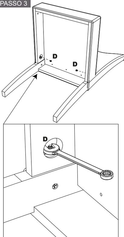
Com a cadeira virada de acordo com a ilustração, coloque a porca 1/4 (D) na ponta da barra roscada e utilize a chave de boca 11mm para fixar o assento (2) no encosto da cadeira (1A ou 1B).
