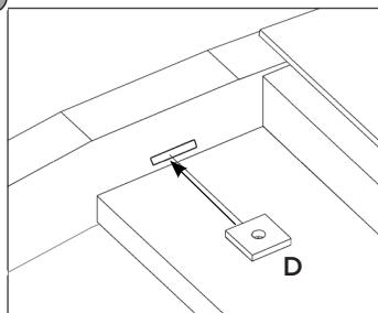
Deixar a Porca Metal (D) com a furação voltada para cima, pois esta, irá se encaixar com a Haste Roscada (C).
