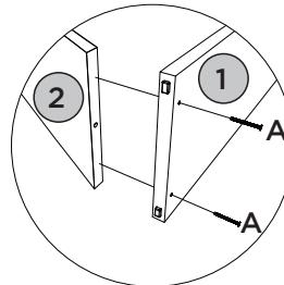
Peça 2 contém furação de topo, sendo essa direcionada e fixada na peça 1.
