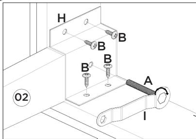
Depois da Chapa (H) deve ser colocado o parafuso (A).
