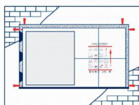
**4.1 - Após a secagem da massa, retire as cunhas e preencha todos os espaços deixados pelas cunhas com massa de cimento devidamente impermeabilizada.**
