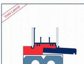
**5 - Término da fixação:** Na parte inferior da esquadria, arremate a peça com reboco preenchendo todos os espaços entre a esquadria, a parede e a pingadeira, lembre-se de deixar o lado externo que está apoiado a pingadeira totalmente livre, para a água poder sair.
