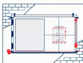
**3.1 - Confira o alinhamento com régua, nível, prumo e estique uma linha na parte inferior da peça para evitar eventuais embarrancamentos. Verifique o esquadrado em 90°.**
