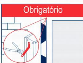
**3 - Preparação da peça para fixação:** abra todas as grapas (chumbadores) existentes na peça.
