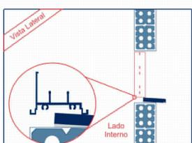
**2.2 - Caso o acabamento seja com uso de vistas (alizares), a instalação da esquadria deve ser feita faceando internamente o acabamento da parede, e não no eixo da parede como foi mencionado no item 2.1**
