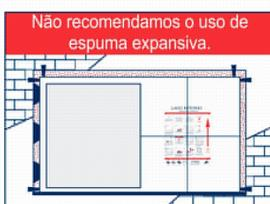
**4 - Início da fixação:** com a peça devidamente calçada, nível e prumo conferidos, comece a fixação com massa de cimento devidamente impermeabilizada, o que aumenta a aderência a alumínio, evitando fissuras e infiltrações. **PREENCHA TODOS OS VÃOS.**
