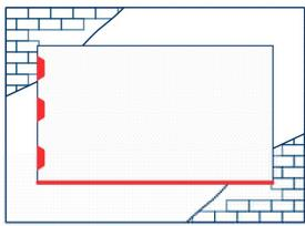
**1 - Preparação da base:** para facilitar a instalação da peça no vão, faça 3 (três) pontos de massa de cimento (munchetas) na parte lateral. Na parte inferior coloque a pedra pingadeira para servir de base para a janela. Faça o alinhamento com régua, nível e prumo e deixe secar para depois colocar a esquadria.
