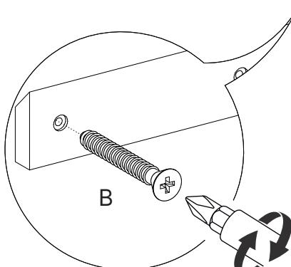
Siga as medidas desse passo para fixar os calços na parede, se caso haja mais painéis mantenha 144mm entre furos de cada calço.
