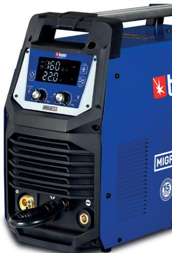
\* **60%** = Dentro de um período de 10 minutos você pode soldar por **6,0 min**, e é obrigado a deixar o equipamento ligado porém sem arco aberto (solda) por **4,0 min**. Lembrando que essa regra vale apenas se a corrente estiver no máximo.
